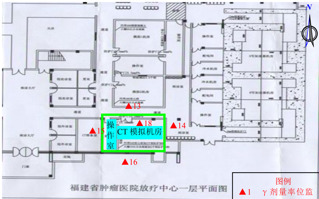
图 6-2 福建省肿瘤医院 ^{125}\text{I} 粒子植入手术室周围环境以及监测点位示意图
